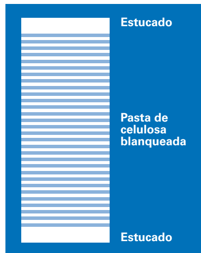
Cartulina estucada blanca (SBB, GZ), estructura multicapa
